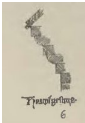
Ryc. 10. Przekrój głównego gzymsu.
